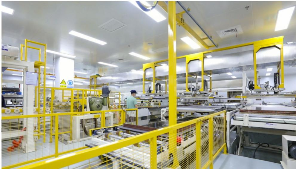
(上图) 甬强科技生产车间内，工作人员将压合成形的覆铜板与模具钢板分离，送入切割机裁剪成客户需要的尺寸。
