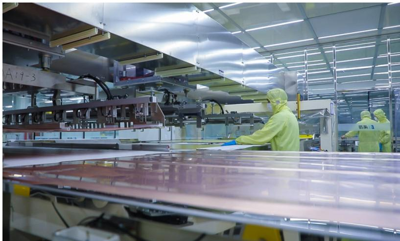
（上图）甬强科技生产车间内，工作人员将电子级铜箔、半固化片和钢板组合在一起，送入压机压合成形。
